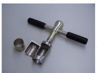
採士部の上部にあるネジをゆるめ、試料 円筒押さえカバーを開きます。採土部に 試料円筒をセットしてカバーを閉め、上 部にあるネジを締めます。
