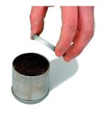
」 試料円筒の上下にフタを取り付け、ビニール テープ等で密封し、試料を持ち帰ります。
