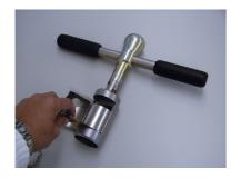
3 土壌採取器を横にし、付属のヘラで試料円筒の下の 土をカットします。
